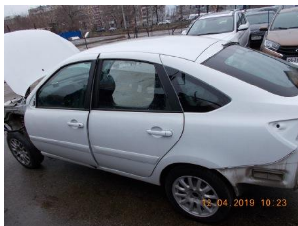
Фото 7.4. Кузов автомобиля с остеклением и частично разукмплектованной ходовой частью Lada 219170 Granta, VIN XTA219170GY207613
