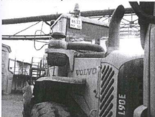
71. Погрузчик колесный одноковшовый VOLVO L90E, состояние: требуется ремонт электропроводки, установить колесо и установить ковш.
