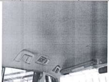
Обивка панели крыши – излом в средней части с образованием складок
